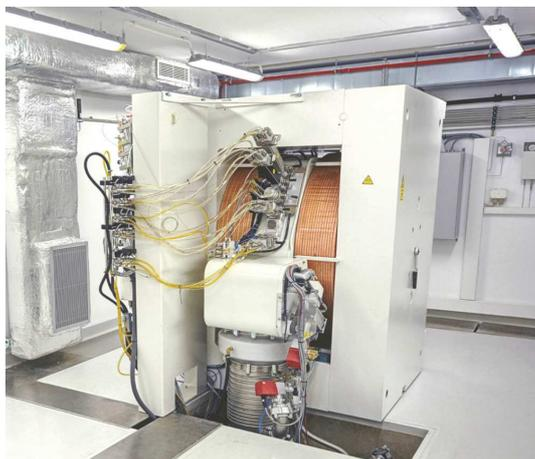
Figure 5: The PETtrace p/d cyclotron.
